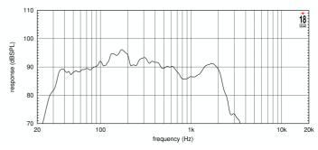
FREQUENCY RESPONSE MADE IN 180 LT. ENCLOSURE TUNED AT 35 Hz IN FREE FIELD (4n) ENVIRONMENT. ENCLOSURE CLOSES THE REAR OF THE DRIVER FREE AIR IMPEDANCE MAGNITUDE CURVE
