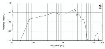
FREQUENCY RESPONSE CURVE MADE ON 50 LIT. ENCLOSURE TUNED 60HZ IN FREE FIELD (4PI) ENVIRONMENT. ENCLOSURE CLOSES THE REAR OF THE DRIVER. FREE AIR IMPEDANCE MAGNITUDE CURVE
